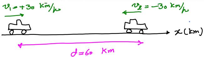
$$v_{12} = v_1 - v_2 = +30 - (-30) = 60 \text{ km/h}$$
